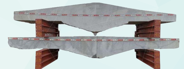
上段：45N/mm 2 (スランプ21cm) 下段：80N/mm 2 (スランプフロー65cm))
